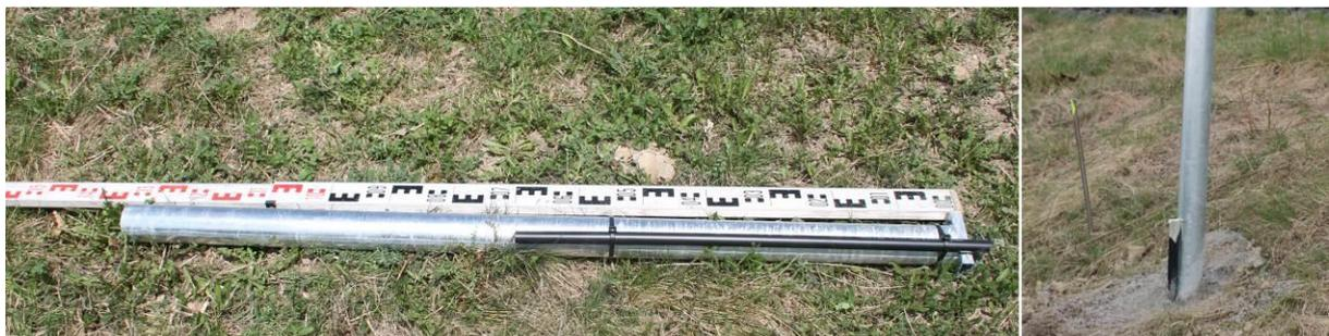
**Bild 11:** Links: Am Fundamentständer befestigte Messgasleitung; Rechts: In den Betonanker eingebaute Messgasleitung
