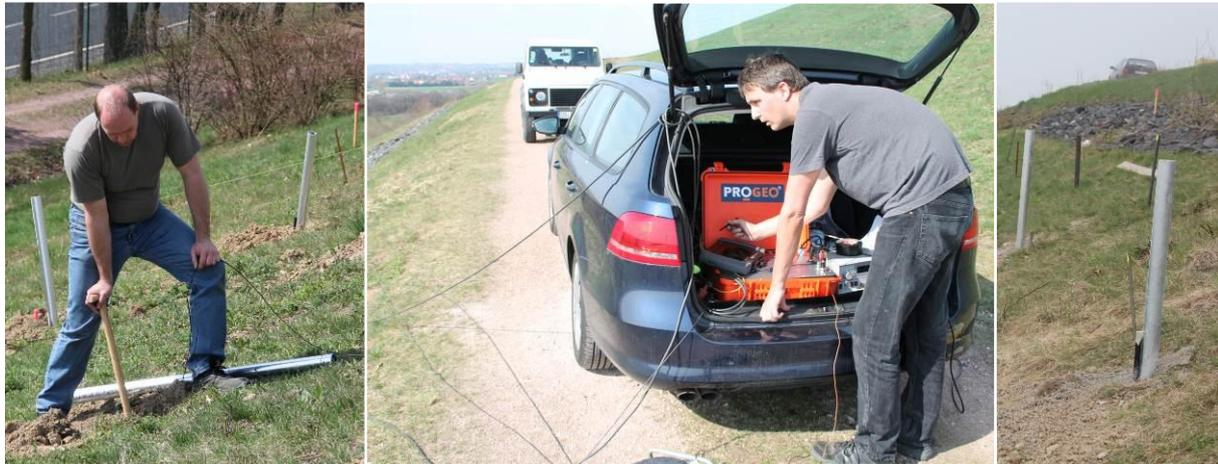
**Bild 13:** Links und Mitte: Erstprüfung vor dem Betonieren mit einer mobilen Elektrode am Grund des Bohrlochs; Rechts: Messung nach dem Betonieren mit einer mobilen Stabsonde durch das Prüfrohr
