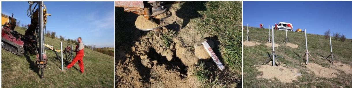
**Bild 8:** Links: Testfeld 1 mit den 3 eingebrachten Drehfundamenten; Mitte: angetroffene Bohrwiderstände; Rechts: Testfeld 2 mit eingebauten Betonankern
