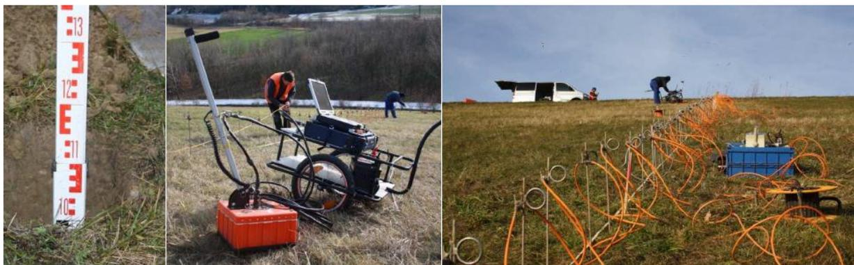
**Bild 1:** Geophysikalische Erkundung der Teufenlage einer KDB auf einer abgeschlossenen Hausmülldeponie; Links: Handschürfe zur Kalibrierung der geophysikalischen Ergebnisse; Mitte: Benutztes Georadarmesssystem; Rechts: 2D-geoelektrische Messung, Messprofil mit einem Elektrodenabstand von 50 cm
