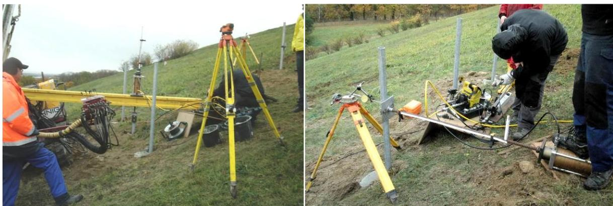
**Bild 9:** Links: Versuchsaufbau axialer Zugversuch am Fundament BF1/2b; Rechts: Versuchsaufbau Schräg-Druck-Versuch am Fundament BF1/1a
