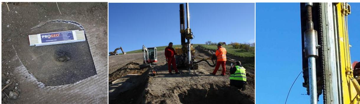
**Bild 12:** Freigelegte Leckage in der Kunststoffdichtungsbahn, Einbohren des Drehfundaments mit Messsonde in das Probefeld
