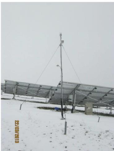
Abb. 2a: Mast und Messgeräte der Klimastation. Gesamtansicht.
