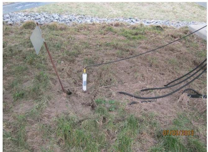
Abb. 2b: Bodenmessstelle unter Solarmodulen mit PR2-Sonde als Gestänge, ML2x-Sonden (eingegraben) und pF-Metern (eingegraben).
